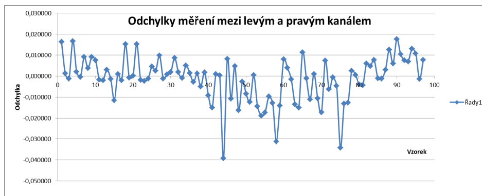
Obrázek 9 Odchylky mezi dvěma naměřenými kanály druhého AD 1939 převodníku
