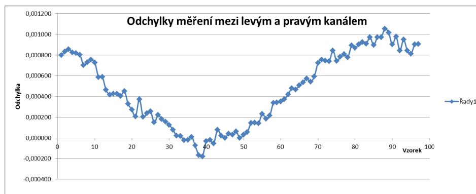
Obrázek 7 Odchylky mezi dvěma naměřenými kanály prvního AD 1939 převodníku
