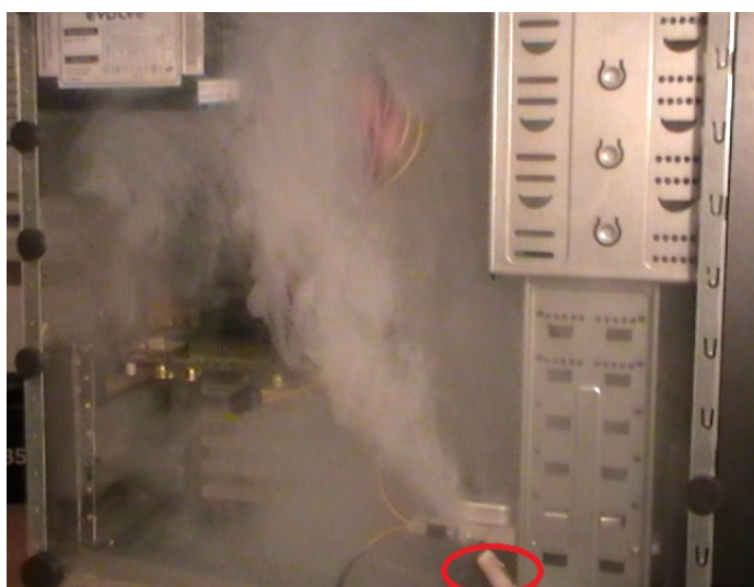
Obr. 3: Vzorová PC sestava s vyznačenou pozicí vyvíječe kouře
