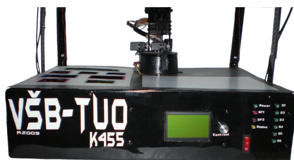
Obr. 1 Fotografie modelu třídičky barevných objektů
