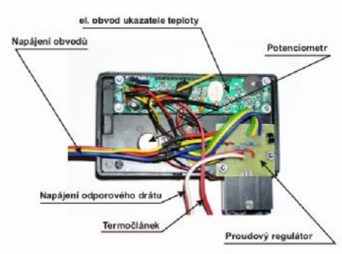
Obr. 3 Vnitřní zapojení mobilního objektu
