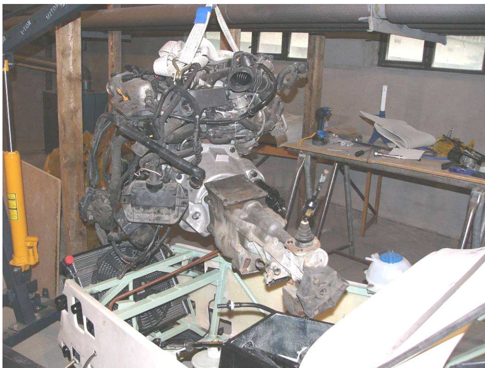
Obr.7. Montáž motoru do rámu vozu
