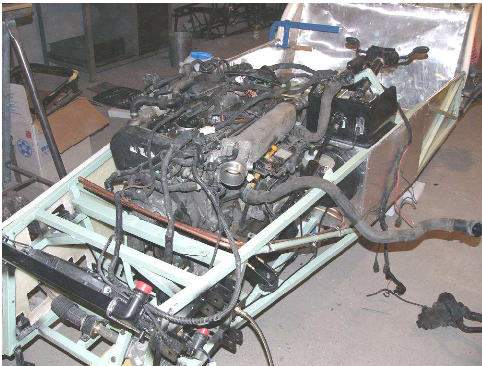
Obr.8. Celkový pohled na motor umístěný v rámu vozu
