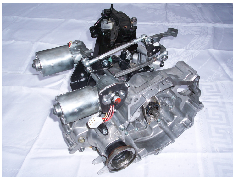
Obr. 8: Řadící paket „by wire“ po montáži na převodovku MQ 200-02T
