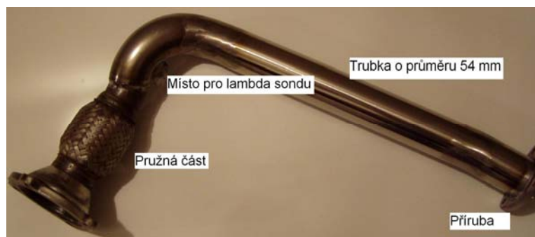
Obr. 5.1 Část výfuk. potrubí vedoucího od turbodmychadla po katalyzátor.
