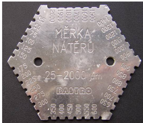
Obr. č. 1: Měrka pro zjištění tloušťky nátěrů BASTRO
