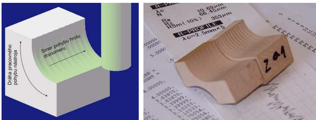
Obr.10 Definovanie smeru merania drsnosti, porovnanie kvality povrchu vzoriek
